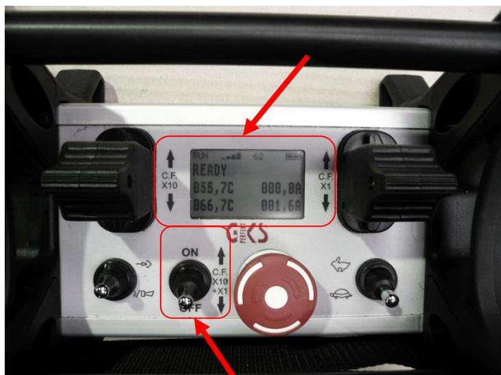
Un commutateur à bascule permet de passer de la direction manuelle à la conduite en ligne droite précise. Cela permet de conduire en marche avant ou en marche arrière avec un seul levier à bascule. Une indication correspondante « sync » apparaît sur l'écran. En outre, la température des deux régulateurs de la commande du moteur est affichée.
