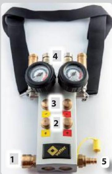
Si le coussin est rempli au-delà de la pression de 8 bar ou à la suite d'une augmentation de la pression dans le coussin due à une sollicitation supplémentaire impévisible du coussin, la valve de sécurité intégrée évacue automatiquement l'air.
